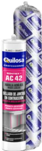
Sellador acrílico para juntas de construcción de bajo movimiento de paneles y estructuras de hormigón prefabricados. AC-42 es totalmente compatible con el hormigón y con elementos de construcción porosos. Homologado por los organismos de certificación más estrictos, como SNJF (F12.5P). Se puede pintar a las pocas horas de su aplicación.
