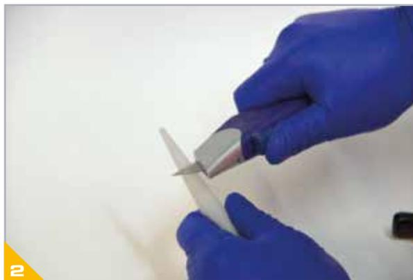
Recortar la boquilla a una anchura en 2-3 mm inferior a la anchura de la junta, manteniendo un ángulo de aprox. 45 grados.
