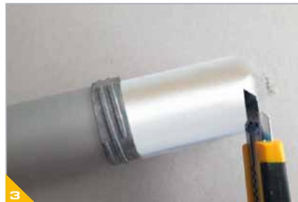
Realizar un corte vertical de aprox. 25 mm de largo en la lámina. No se tiene que eliminar la parte superior de la lámina para asegurar la salida correcta del sellador.
